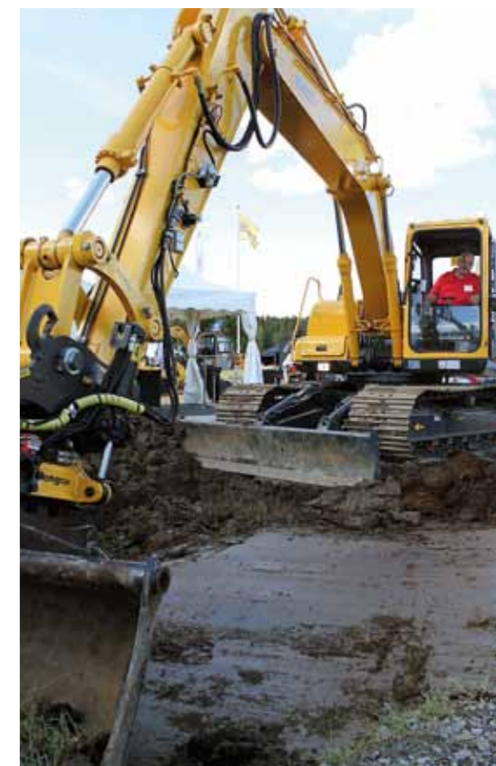
Med OneDig-systemet kontrollerar du skopans rörelser och gräver jämna ytor utan onödig påverkan på schaktbotten – det sparar material, tid och miljön.
